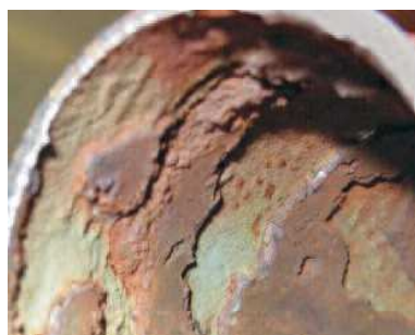
Korozja w postaci rdzy i kamienia
